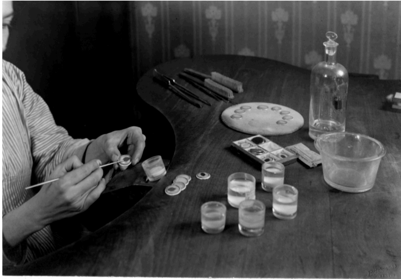
Emaillage à la "pointe" d'une surface plane.
