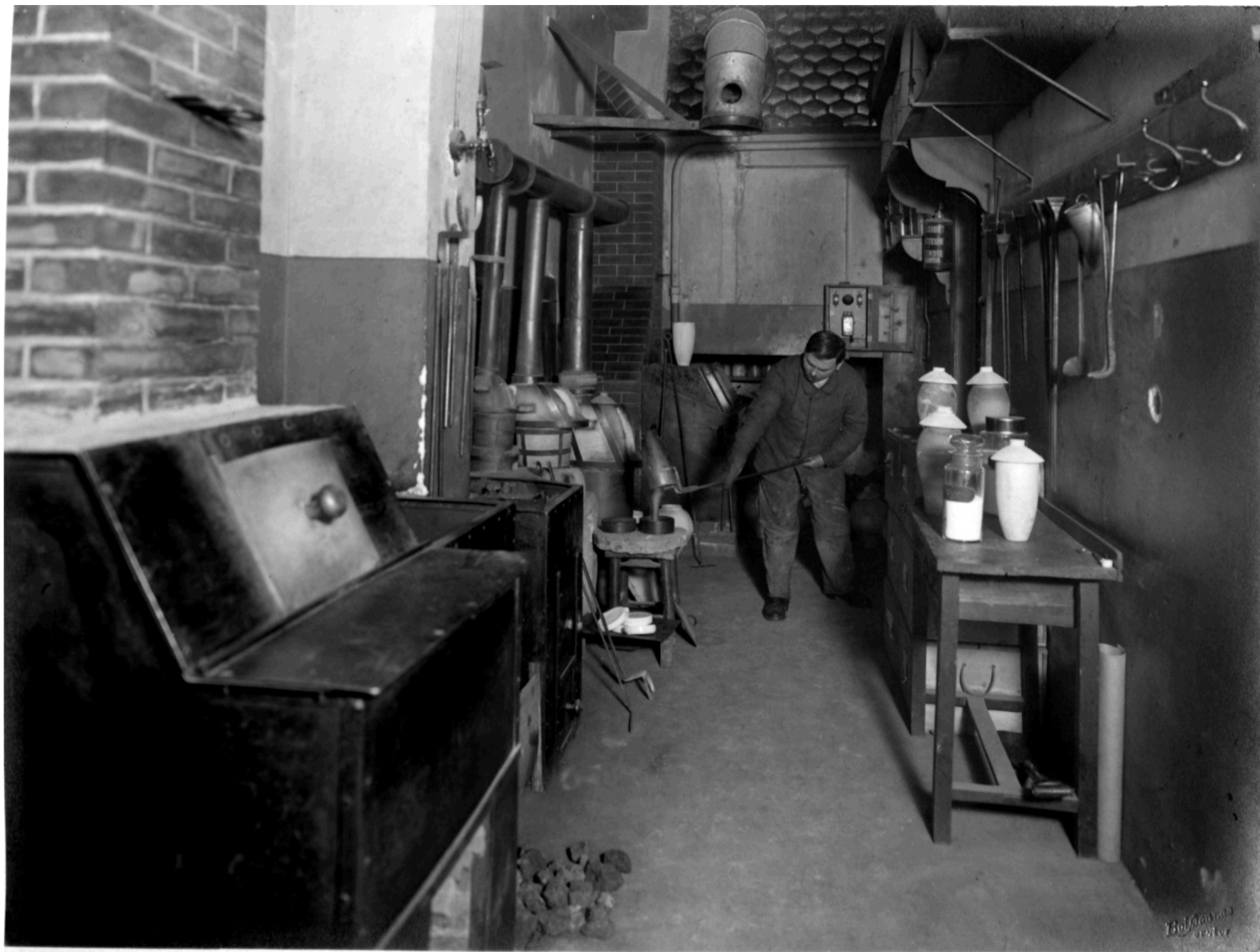
Local des fours (coulée d'une fonte d'émail)
