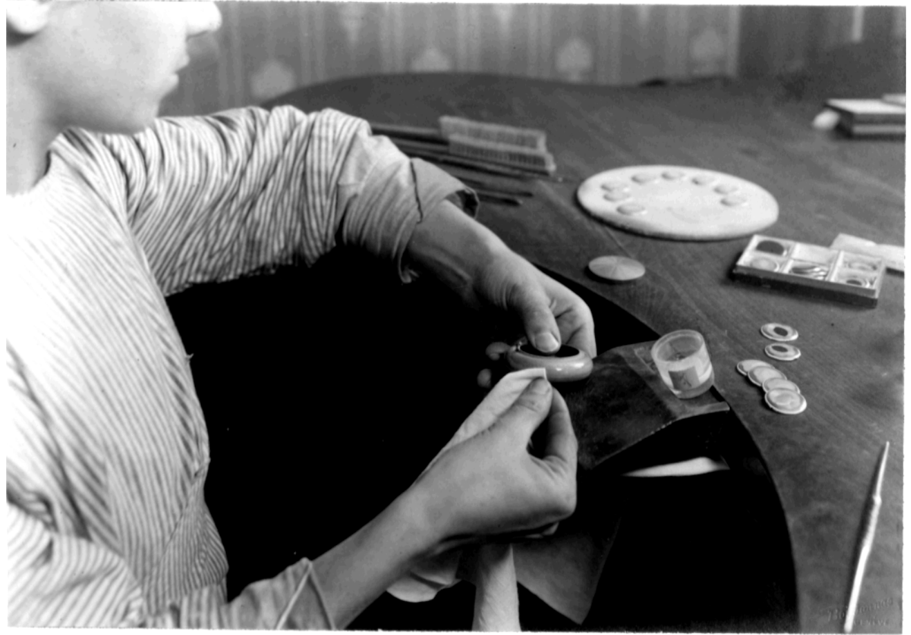
Essorage d'un objet après l'émaillage.
