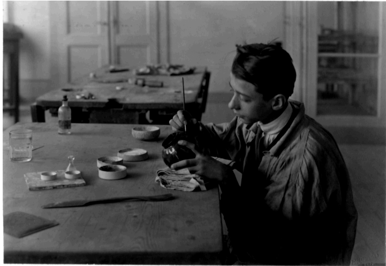
Émaillage au pinceau d'une pièce de forme.
